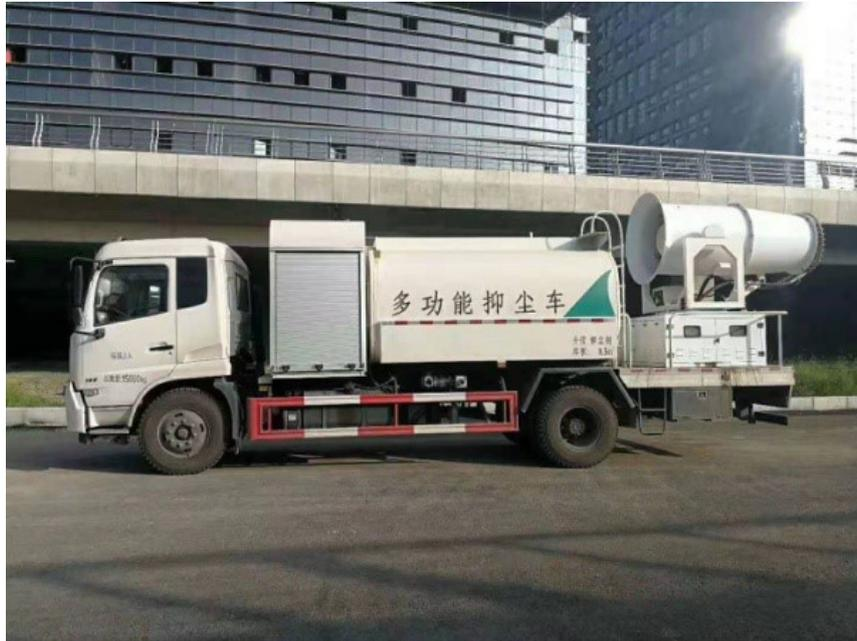
多功能抑尘车是一种新型的除尘产品。它利用空气射流动力学原理将高压水雾化成不同粒径的水滴。它由高压高速风束加速并运输到所需的特定空间。雾化水滴被空气中的雾气，尘埃颗粒和其他颗粒悬浮液吸附，水通过重力从空气中滴落到地下，达到了喷雾降尘和空气净化的目的，具有以下功能：浇水和道路冲洗。能有效\*\*\*尘埃的产生。多功能抑尘车与普通喷水喷头不同。设备喷洒的不是小水滴，而是喷洒超细水雾。雾粒小，可以实现精确喷雾。雾量可根据不同需求进行调整。
